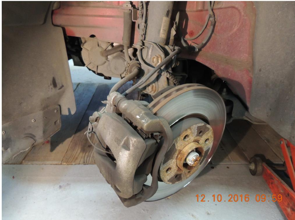
Débranchez le capteur d'usure des plaquettes et libérer le câblage de l'agrafe intermédiaire.
